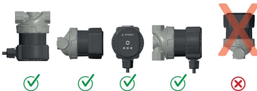
Obr. 2 Příпустné montážní polohy pro čerpadlo APW
